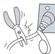
Не применяйте удлинители силовых линий и не используйте розетку для одновременного питания другой электрической аппаратуры. Это может привести к поражению электрическим током и возникновению пожара.
