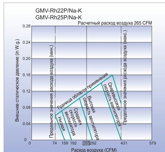
**Инверторная мультизональная система VRF с компрессором постоянного тока и рекуперацией тепла**
