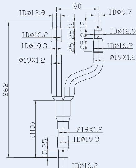
**Газовая труба высокого давления**
