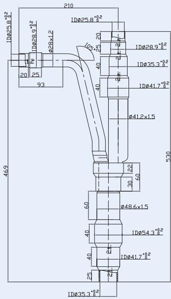
**Газовая труба высокого давления**
